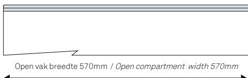
Vooraf te boren gaten: Boor afhankelijk van de rompbreedte, de benodigde gaten in de muur. Open vakken hebben geen ophangers: houdt wel rekening met de breedte bij het uitmeten van de boorgaten.
