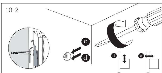
Bij rompen van 85,5cm en 114cm breed, zonder separatie in het midden, wordt bovenstaande ophanger toegepast. Draai deze ook in diepte uit (schroef c).
