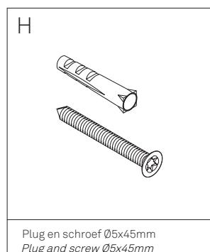
Plug en schroef Ø5x45mm
