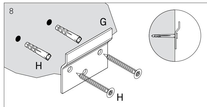
Sla de pluggen (H) in de geboorde gaten en schroef vervolgens de ophangplaten (G) vast mbv de bijgeleverde schroeven (H).
