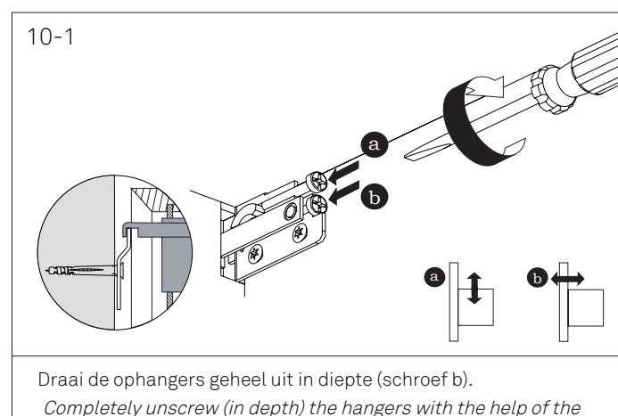
Draai de ophangers geheel uit in diepte (schroef b).
